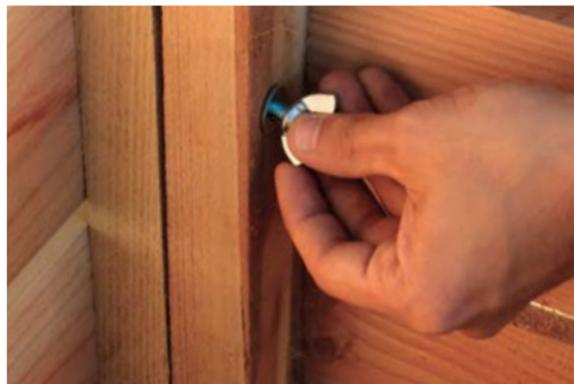
Assembler ces deux faces à l'aide de boulons têtes rondes à collets carrés en mettant les rondelles et les écrous papillons à l'intérieur du composteur. Il est conseillé de taper sur la tête ronde du boulon avec un petit marteau pendant que l'on visse l'écrou afin de bien serrer l'ensemble.
