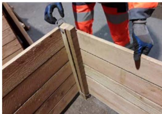
Glisser la face avant dans les ferrures métalliques du bas, relever la face et rabattre les ferrures du haut pour bloquer l'ensemble.
