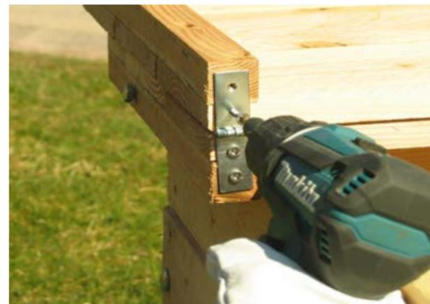
Positionner les 2 parties du couvercle l'une sur l'autre, les charnières préposées face à vous et entre les deux éléments du couvercle. Fixer la charnière sur les emplacements pré-perçés.
