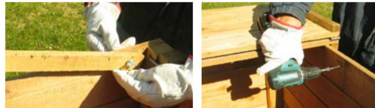
Fixer le bras de maintien à l'aide du boulon à tête ronde (tête bombée vers l'extérieur), une première rondelle en entretoise entre la paroi du composteur et le bras de levier et une seconde avant l'écrou frein (emplacement boulon pré-percé).
