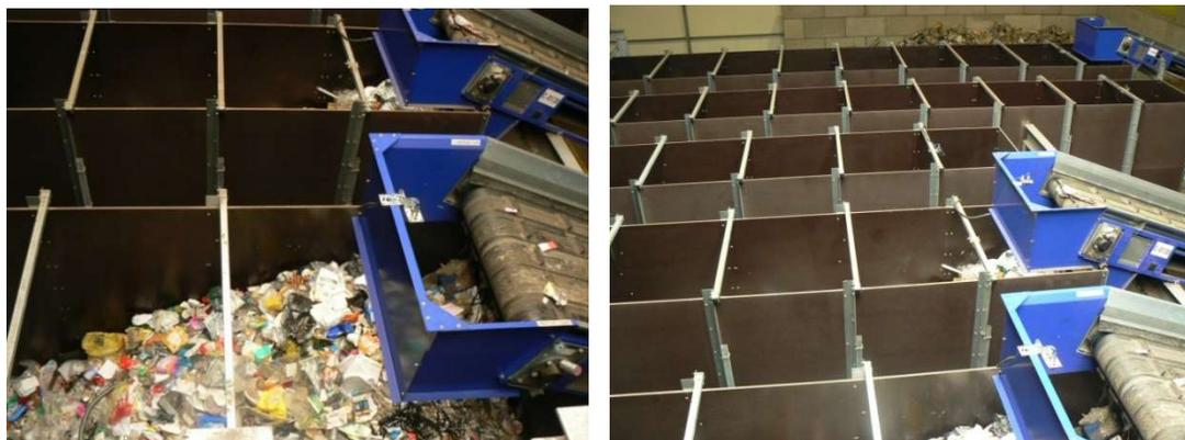
*Box de stockage des matériaux avant conditionnement (ex du box de refus de tri)*
