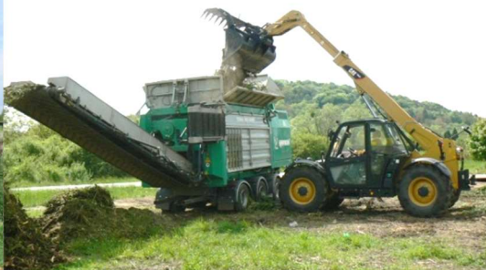
Broyage des déchets verts
