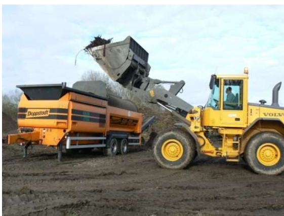
Criblage du compost
